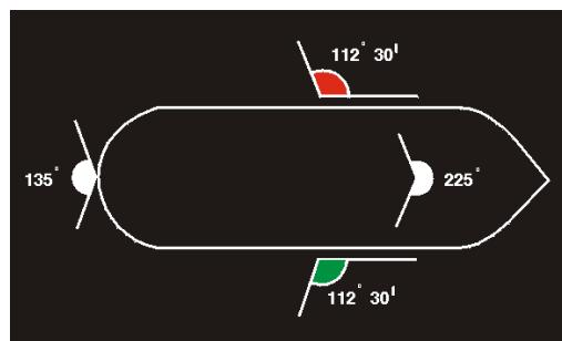
Član 3.01, stav 1: Horizontalni luk duž kojeg se vide jarbolno svjetlo, bočna svjetla i krmeno svjetlo
